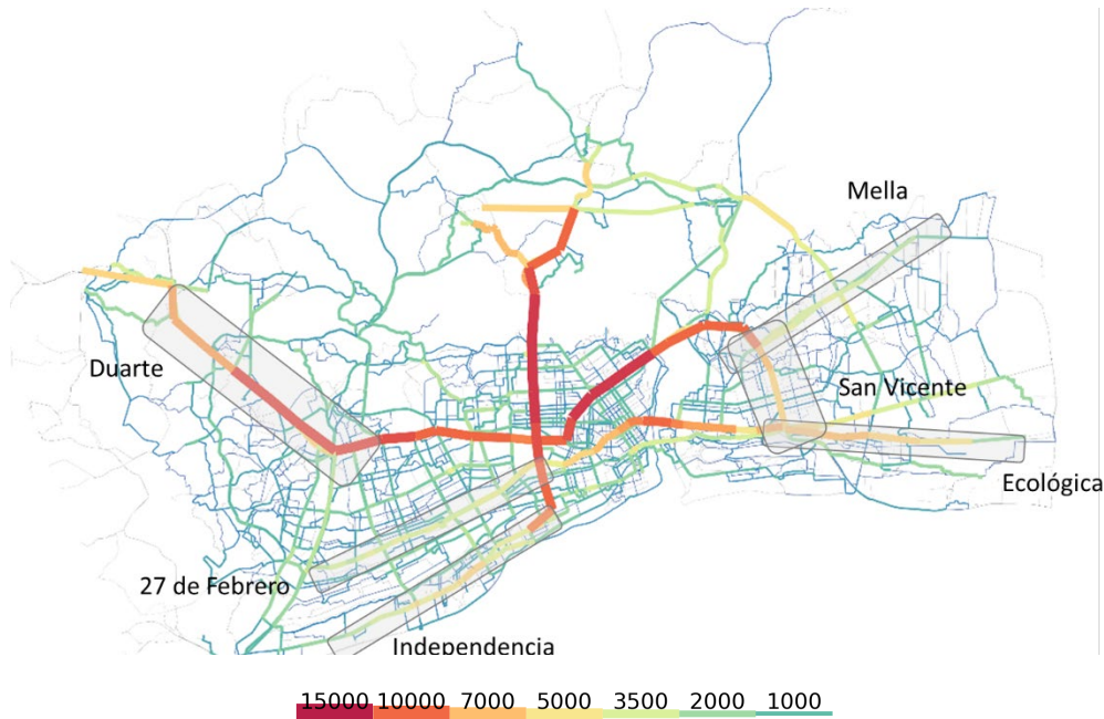
Ilustración 57 –Ejes metropolitanos para servir con transporte masivo, de acuerdo con la demanda en el escenario base (desplazamientos en hora pico) – Fuente: SYSTRA
