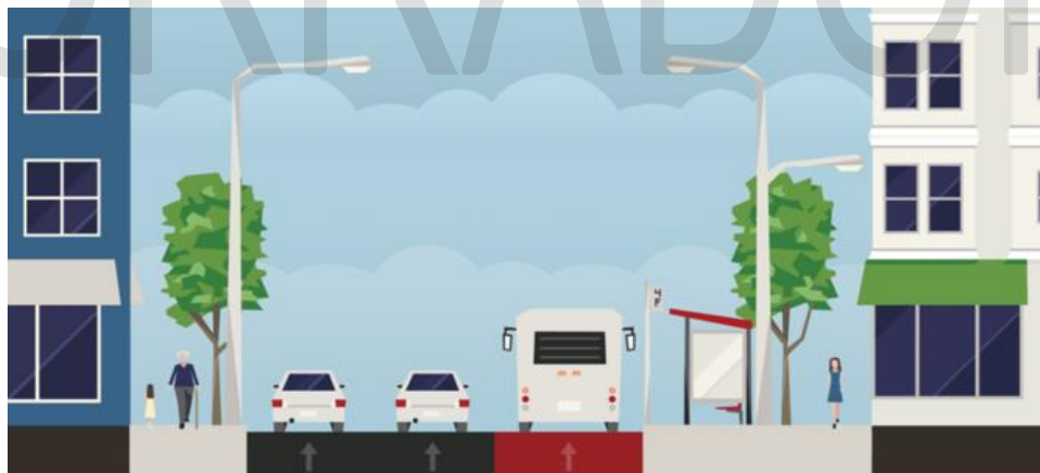
Figura 31. Corte trasversal propuesto para la Av. Pedro Henríquez Ureña entre av. Lincoln y Av. México
