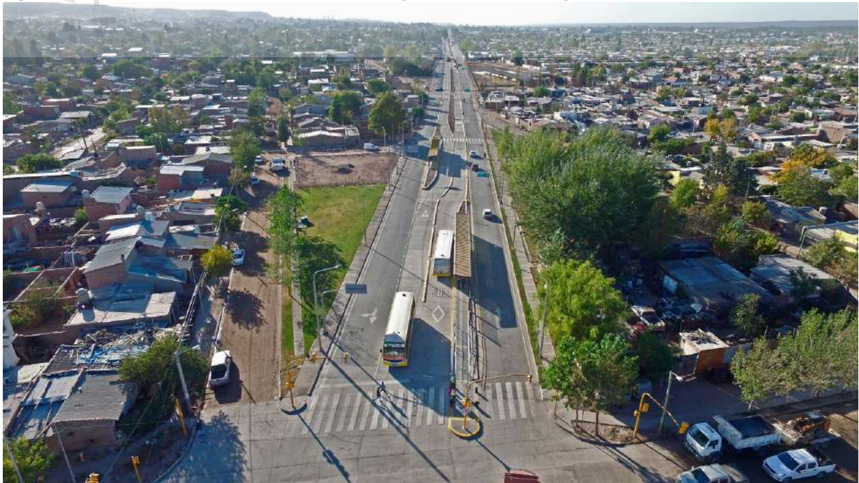
Figura 66. Sistema con estaciones escalonadas y sin carril de sobrepaso.
