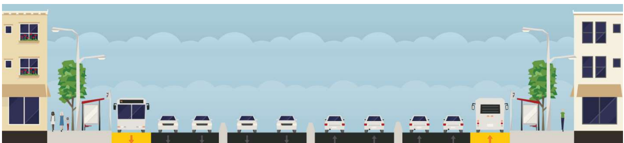
Figura 73. Corte transversal propuesto para la Av. John F. Kennedy
