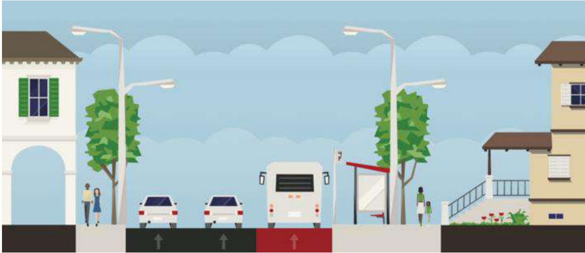
Figura 79. Corte transversal propuesto para la Av. Correa y Cidrón entre Av. Máximo Gómez y Av. Italia
