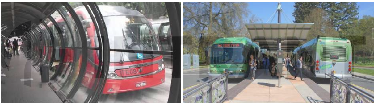
Figura 61. Tipología de estación cerrada (Transmilenio, Bogotá, Colombia) y semiabierta (BRT Max, Colorado, EEUU).
