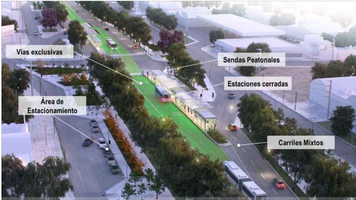
Figura 62. Esquema funcional de BRT
